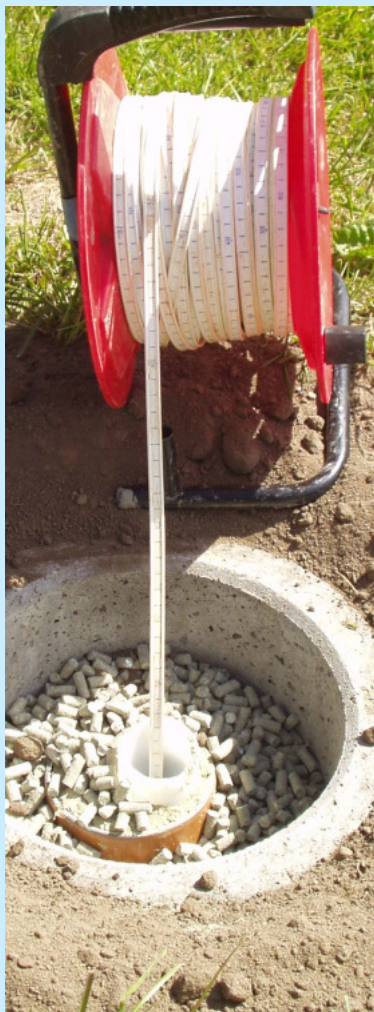
Overvågningsboring hvor der pejles.
