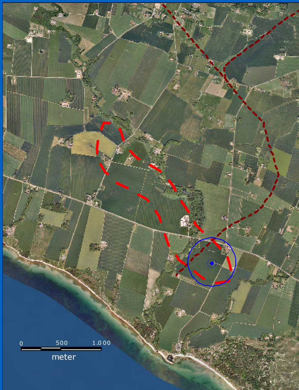
Luftfoto med nærområdet, indvindingsboringen, kloakledningen (indsats 4) og 300 m-zonen omkring boringen (indsats 7 og 8)
