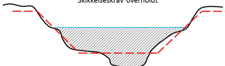
Figur 3: Principskitse af opmålt skikkelse. Betegnelserne er de samme som i figur 2. Det skraverede område angiver tværsnitsareal opmålt . Det er dette tværsnitsareal, som reelt forefindes i vandløbet ved en vilkårlig vandstand. I dette eksempel er skikkelseskravet opfyldt, da tværsnitsareal opmålt er større end tværsnitsareal teoretisk .
