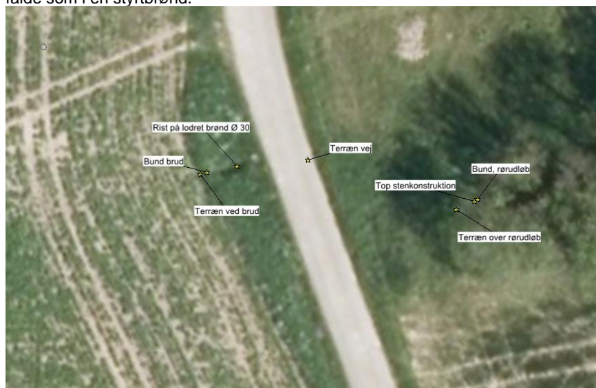
Figur 5.8: Erosion (betegnet brud på kortet), rist og brønd tæt på vejunderføring.
