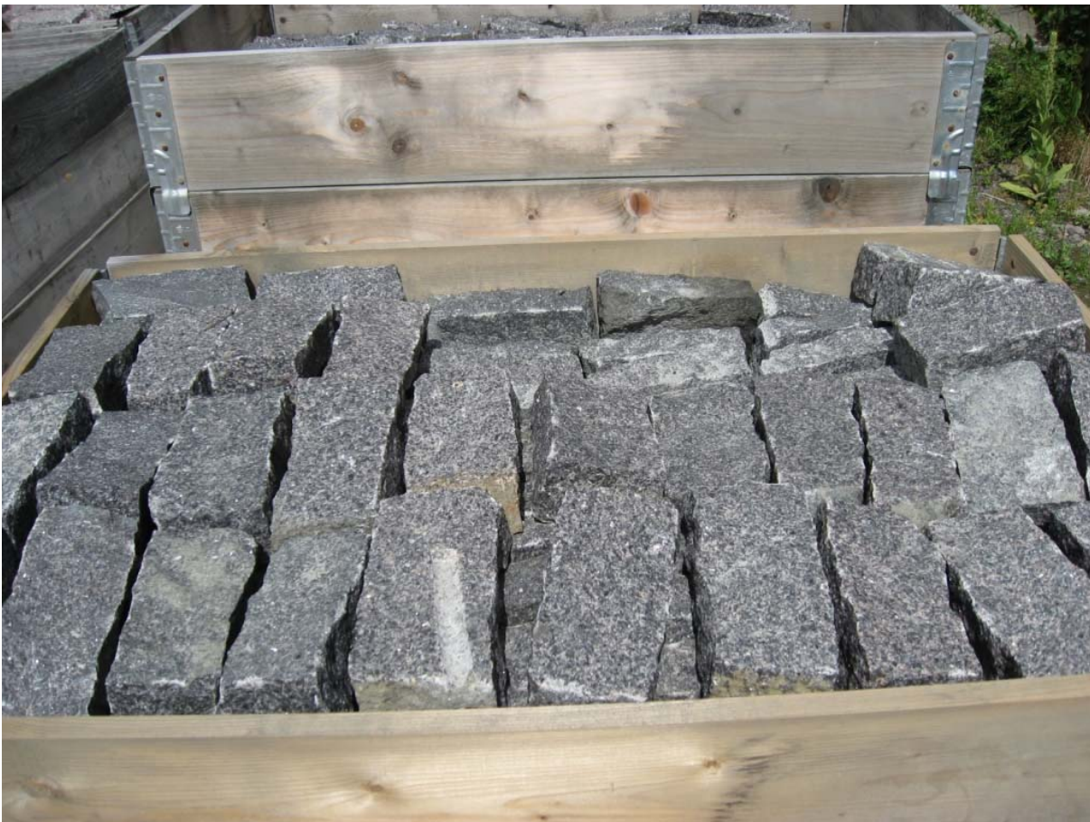
Klippeløkken. Kasser med færdigbearbejdede kantsten fra granitbruddet Klippeløkken, som er klar til afhentning, så de kan blive udskibet fra Rønne Havn.
