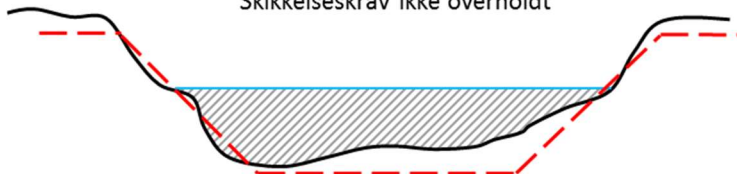
Figur 4: Principskitse af opmålt skikkelse. Betegnelserne er de samme som i figur 3. Det skraverede område angiver tværsnitsareal opmålt . Det er dette tværsnitsareal, som reelt forefindes i vandløbet ved en vilkårlig vandstand. I dette eksempel er skikkelseskravet ikke opfyldt, da tværsnitsareal opmålt er mindre end tværsnitsareal teoretisk .
