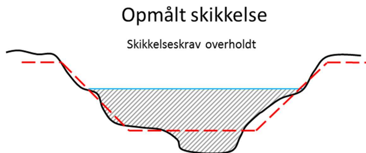
Figur 3: Principskitse af opmålt skikkelse. Betegnelserne er de samme som i figur 2. Det skraverede område angiver tværsnitsareal opmålt . Det er dette tværsnitsareal, som reelt forefindes i vandløbet ved en vilkårlig vandstand. I dette eksempel er skikkelseskravet opfyldt, da tværsnitsareal opmålt er større end tværsnitsareal teoretisk .
