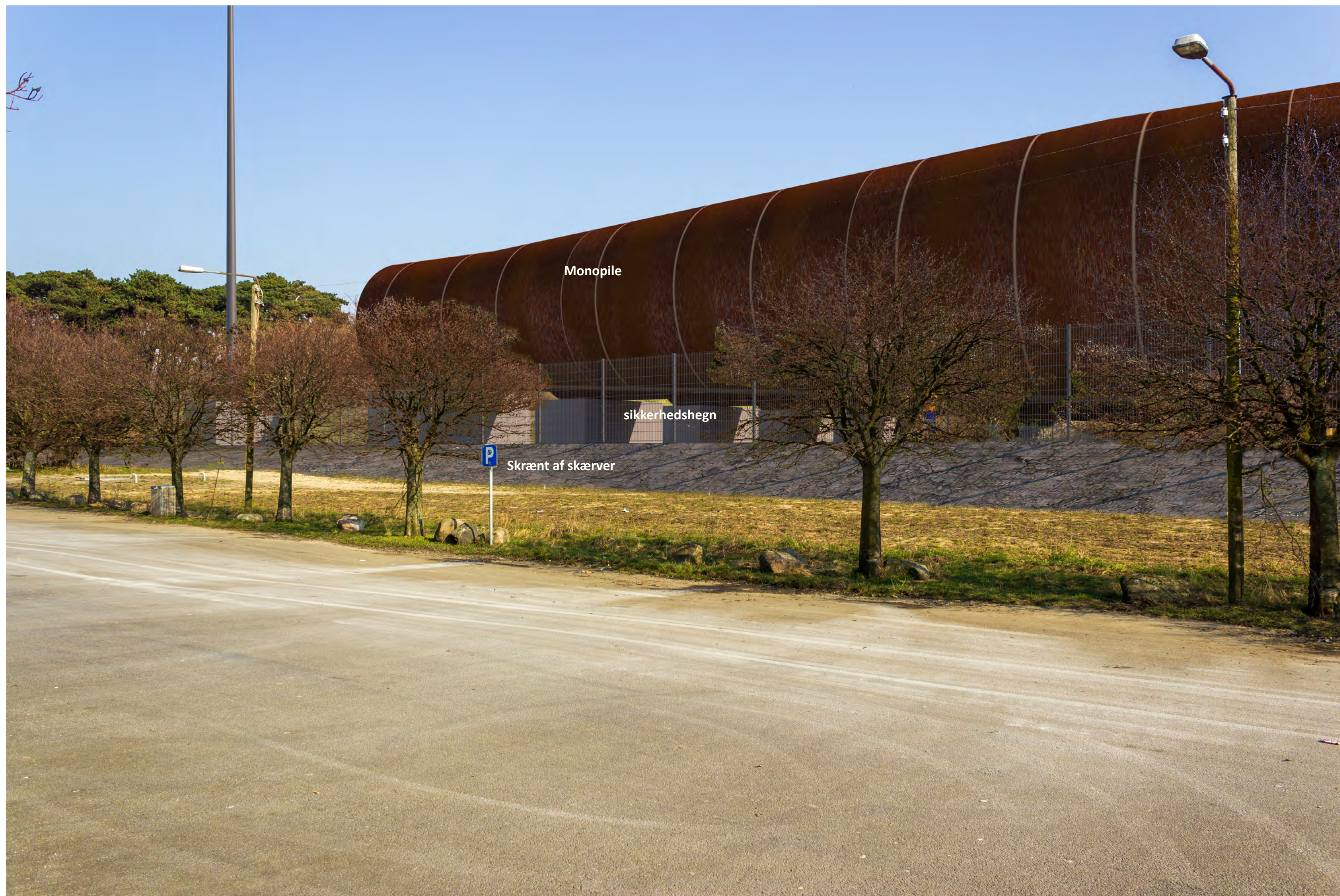
Fotostandpunkt 1 - Visualiseringen viser kanten af havneudvidelsen, et nyt skærvedækket område med topkote 3,5 m, en skrænt mod eksisterende terræn, nyt sikkerhedshegn og opklodset monopile.
