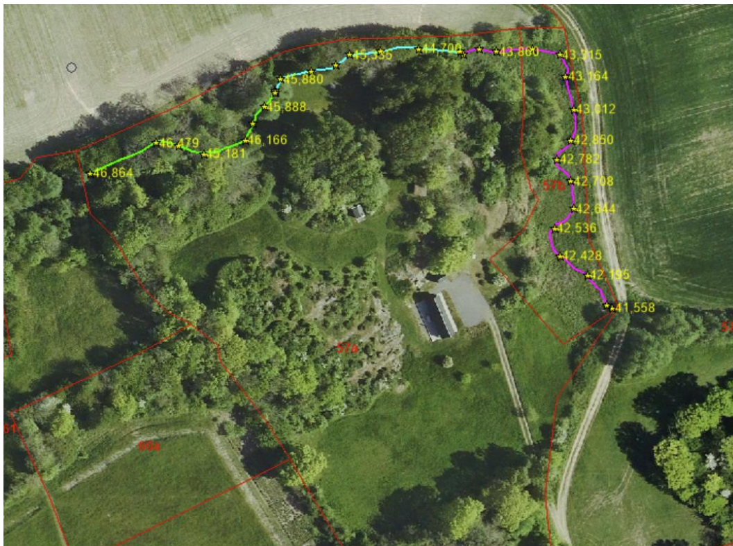
Figur 3: Kortet viser de opmålte koter i vandløbsbunden (kilde: Ansøger).
