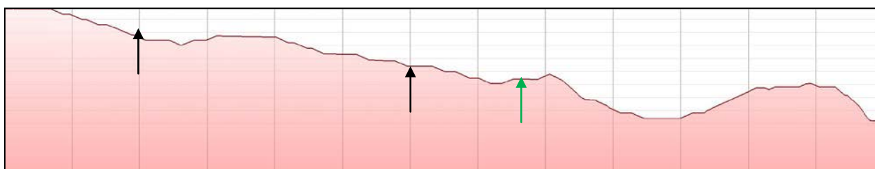
Figur 5: Terrænprofil fra matriklens vestlige kant ud mod havet. De sorte pile angiver matrikelgrænsen 17 m.o.h. mod vest til venstre, og lokalplanafgrænsningen 11 m.o.h. mod øst til højre. Den grønne pil angiver Kannikegårdsvejens niveau.
