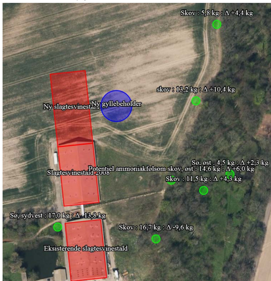
Figur 10. Beregningspunkter for ammoniak i skoven øst for Ladegård. Første tal angiver totaldeposition fra Ladegård, og tallet efter trekanten angiver merdeposition i forhold til indtastet nudrift, som er den oprindelige nudriftssituation før miljøgodkendelsen fra 2014
