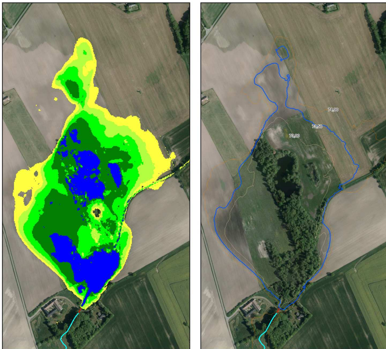
Figur 19 Afvanding ved forslag 1 sammenlignet med konturer. Ved medianmaksimum sker der oversvømmelse op til den blå linje (kote 73,50) på figuren til højre. Se Bilag D for flere detaljer.
