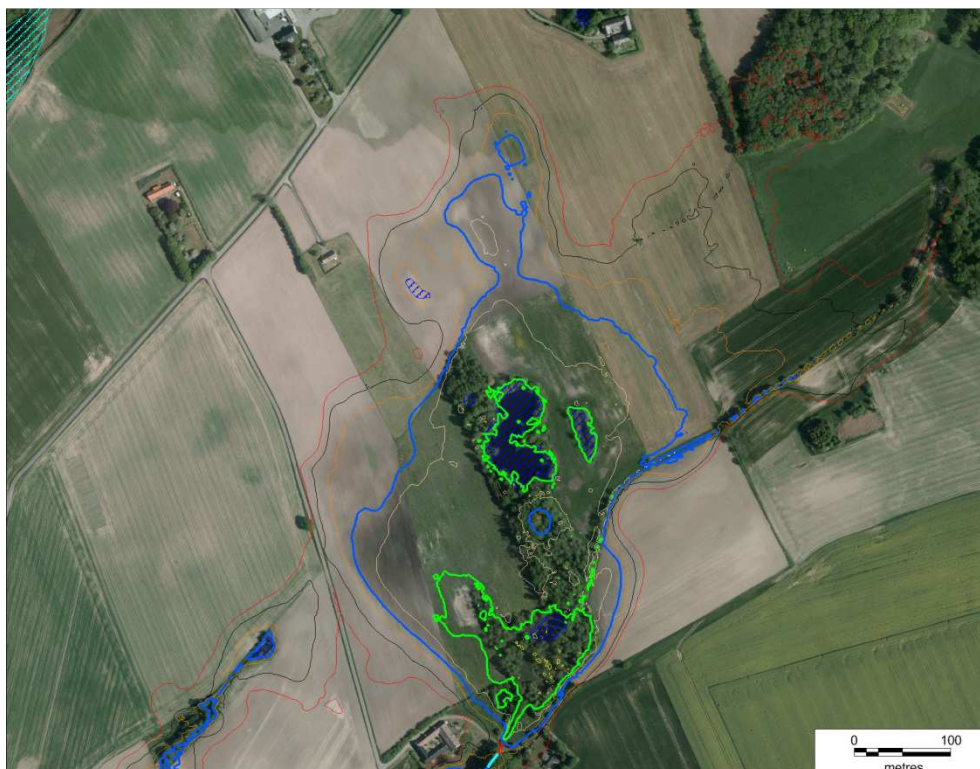
Figur 18 Højdekurver for Krummemosen. Oversvømmelsen ved medianmaksimum er nu nogenlunde som vist med den blå streg (73,5 m), men vil med projektet reduceres til den grønne streg (72,5 m). Oversvømmelsen dækker de § 3-beskyttede søer (skraverede).
