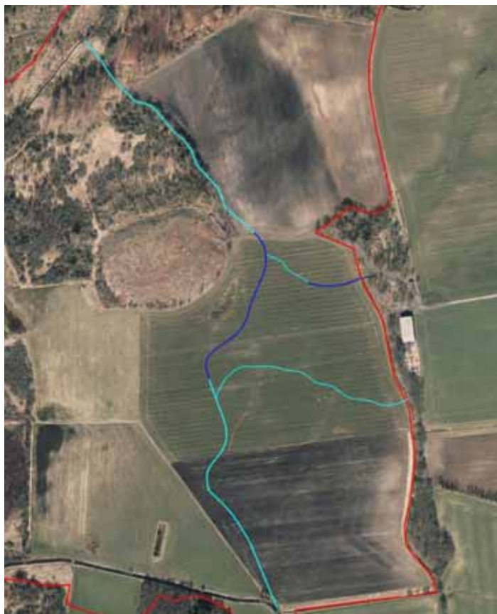
Figur 13-3 Udlægning af gydegrus (mørk blå). Faldet på den viste strækning med gydegrus i Læså er 3 ‰. På det mindre tilløb er faldet 5 ‰ på den pågældende strækning, men faldet vil kunne varieres, så der bliver nogle strækninger med lidt mindre fald.
