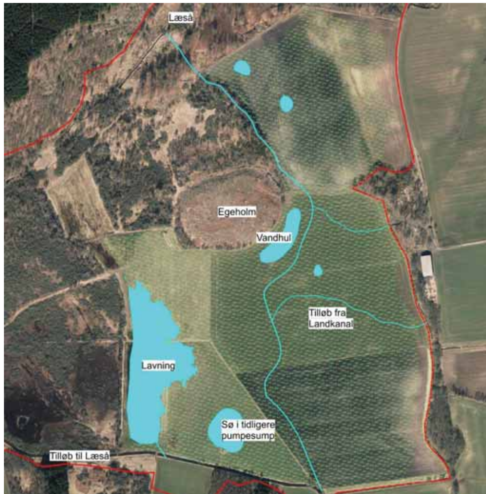
Figur 2-3 Vallenskær. Pumpestationen fjernes og drænene afbrydes. Genskabt eng/mose er vist med grøn skravering. Blå flader viser lavningen øst for Kærgård Mose, nye småsøer og paddeskrab. Vandstanden vil variere gennem året, og de viste lyseblå flader vil kun være vanddækkede ved meget høj vandstand. Blå streg viser vandløbets nye forløb.
