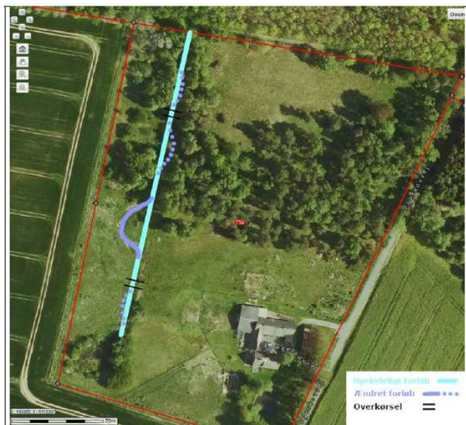
Figur 2: Kortet viser projektområdet herunder: Det eksisterende vandløb med en turkisblå linje, den foreslåede nye linjeføring med en violet stiple linjeføring. Den strækning på kortet, som er markeret med violet optrukket linjeføring er allerede genslynget. Der ses også to overkørsler med to sorte streger. Disse har været etableret for længe siden.
