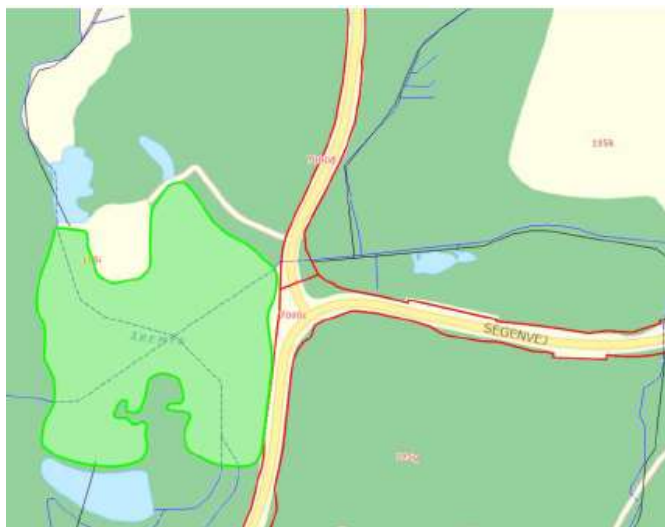
Figur 4: På kortet ses grøfter (stiplede blå streger), vandløb (blå streger) og målsatte vandløb (sorte streger) (Kilde: Kortinfo).
